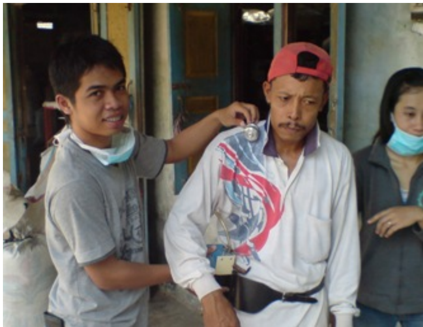
Gambar 4. Pemasangan Personal Dust Sampler Pada Pekerja
