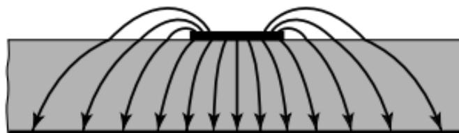
Gambar 2.13 *Fringing Effect* pada saluran transmisi [17]
