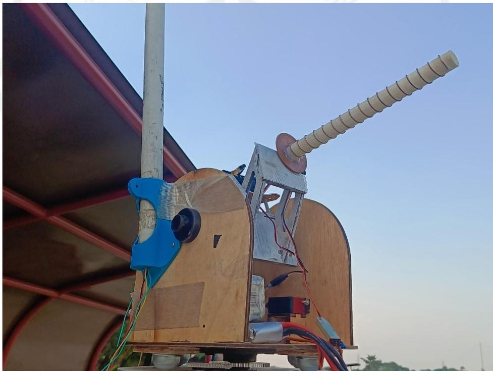
Gambar 4.26 Antenna tracker dengan Helical Antena
