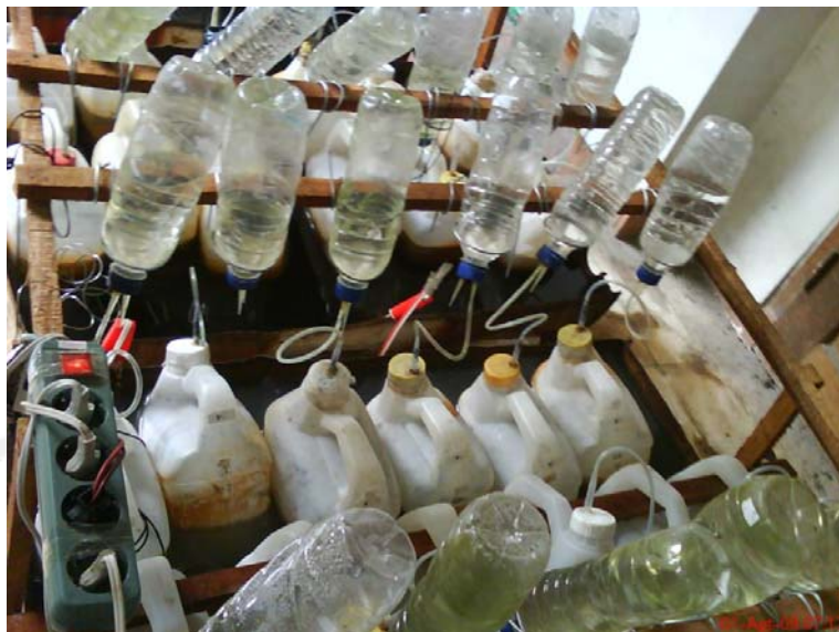
c. Rangkaian Biodigester Anaerob pada Suhu Termofilik
