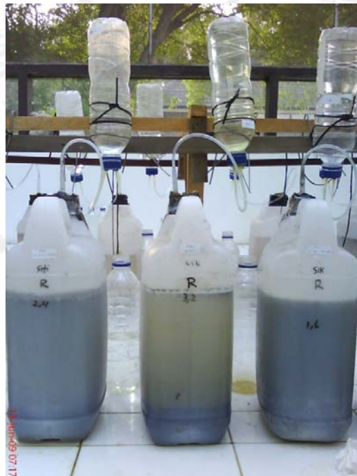
b. Rangkaian Biodigester Anaerob pada Suhu Ruang
