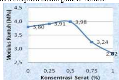
Gambar 11. Grafik Hubungan Modulus Runtuh dan Konsentrasi Serat
