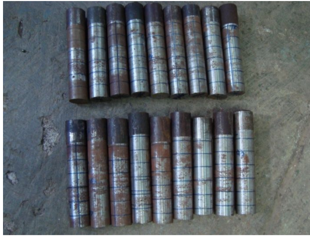
Gambar 3.7 Benda kerja St 37 sesudah dibubut.
