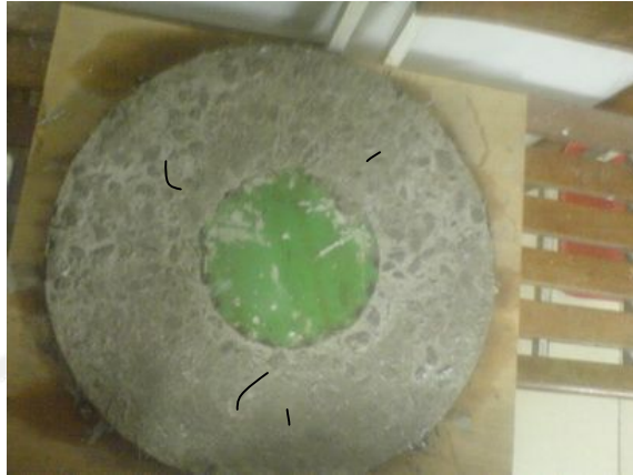
Gambar 4. 13 Beton Agregat Daur Ulang Serat Ban.
