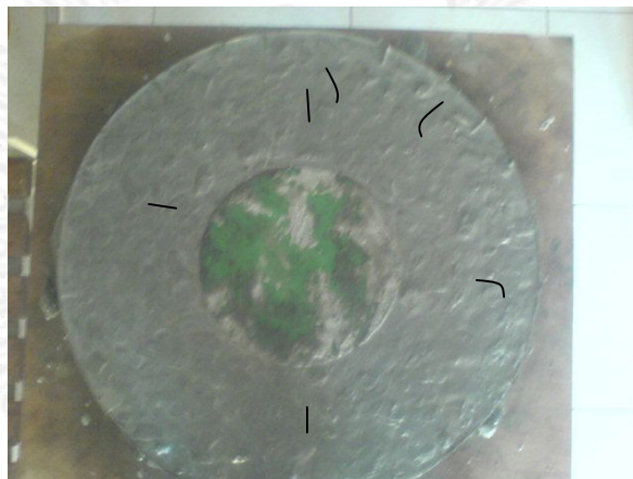
Gambar 4. 17 Beton Agregat Daur Ulang Tanpa Serat.
