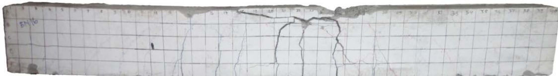
Gambar 9. Pola Retak Benda Uji Balok Kontrol (C)
