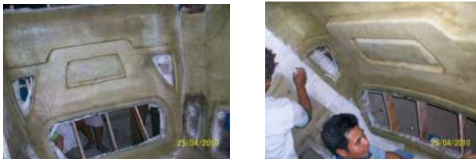
Gambar 4.12. Proses laminasi pada bagian yang disambung
