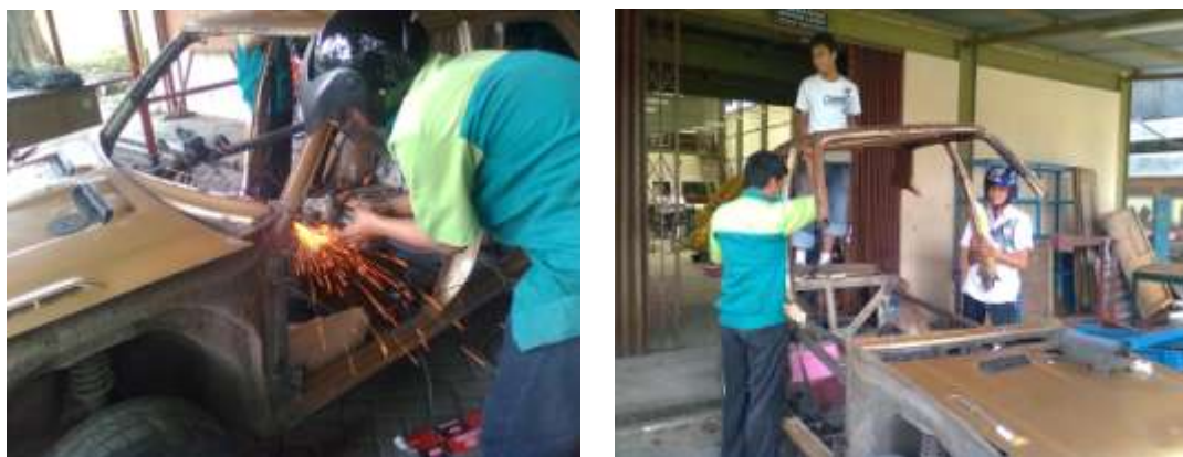
Gambar 3.6. Proses pemotongan bagian - bagian yang tidak digunakan
