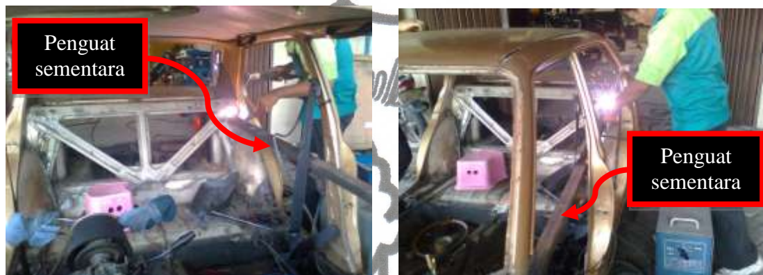
Gambar 3.3. Pemasangan penguat sementara pada chasis
