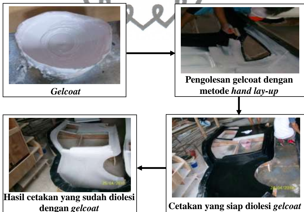
Gambar 4.10. Proses pembuatan lapisan gelcoat
