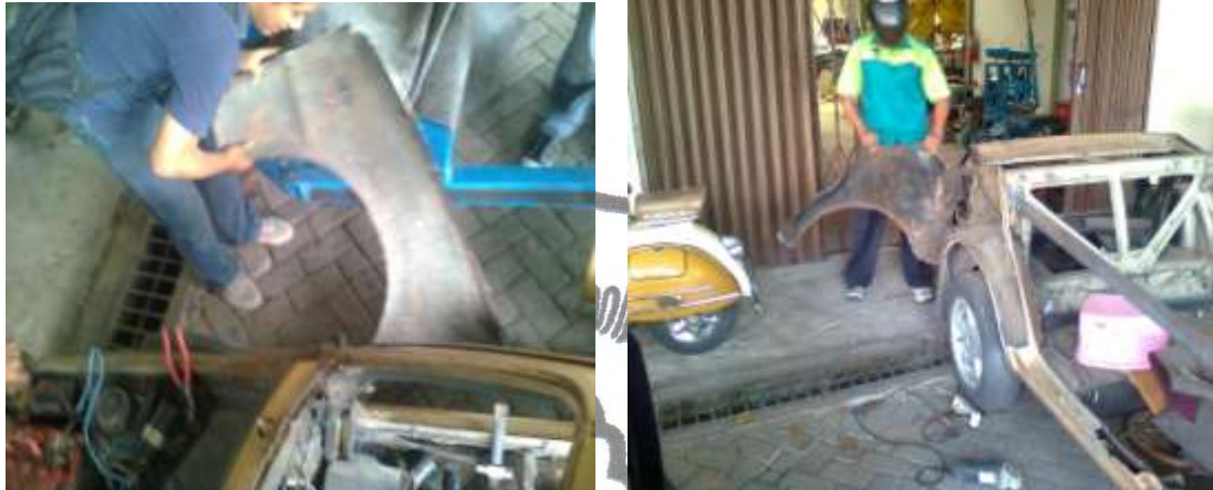
Gambar 3.5. Pemotongan chasis bagian depan dan belakang
