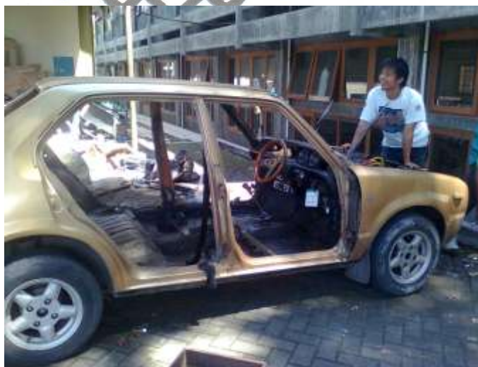
Gambar 3.2. Proses pelepasan bagian-bagian dari interior
