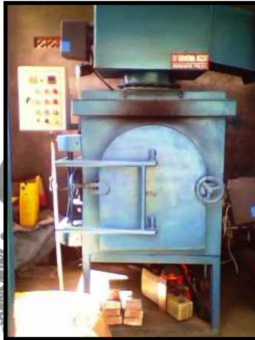
Gambar 2.3 Gambar Ruang Pembakaran Insinerator
