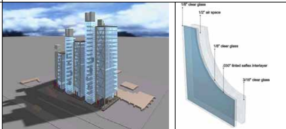
Gambar 2.28 Airy structure pada 88 Woodstreet dan kaca inter layer sebagai inovasi baru sumber: www.greatbuildings.com
