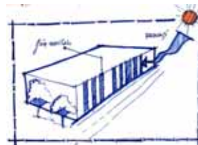
(Gambar 6.8 Sirip-sirip vertical untuk mereduksi panas)
