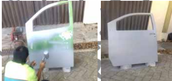
Gambar 3.22. Proses pengecatan dasar
