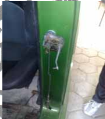
Gambar 3.17. Mekanisme kunci manual
