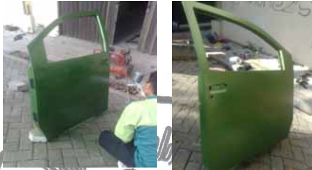
Gambar 3.24. Proses pelapisan clear
