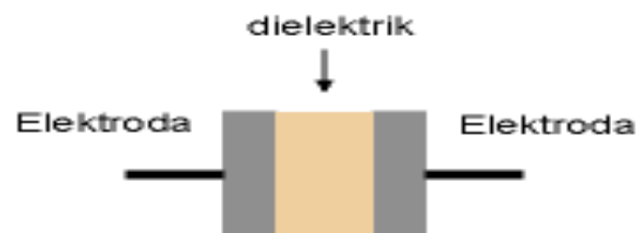
Gambar 2.24 Prinsip dasar kapasitor
