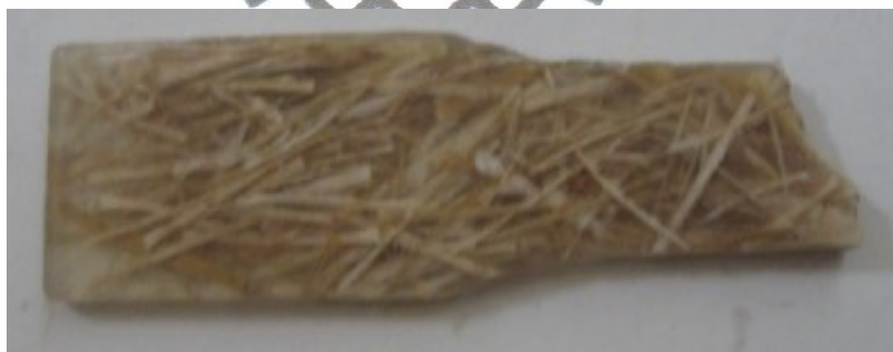
Gambar 5.10 Permukaan patah pada skin komposit dengan perlakuan alkali
