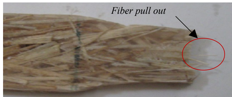
Gambar 5.9 Permukaan patah pada skin komposit tanpa perlakuan alkali
