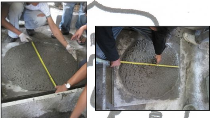
Gambar 4.9. Pengukuran nilai slump flow
