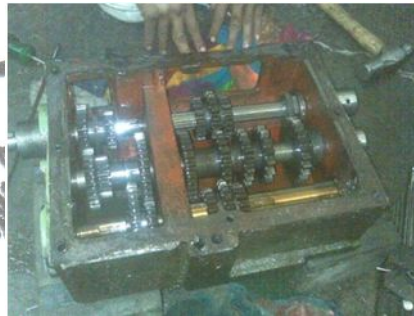
Gambar 4.33. Gearbox Pengatur Kecepatan Otomatis Pahat
