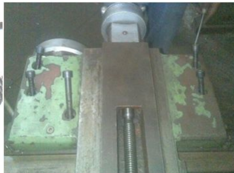
Gambar 3.7. Melepas baut pada eretan melintang.
