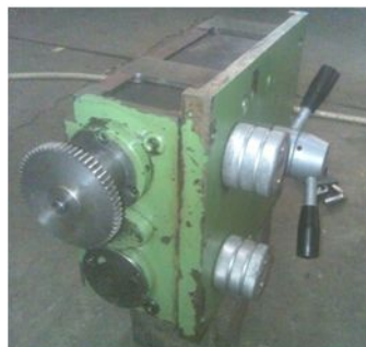
Gambar 4.34. Gearbox pengatur kecepatan otomatis pahat.
