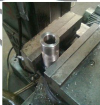
Gambar 4.30. Pembuatan slot pasak (spi) pada satu ujung
