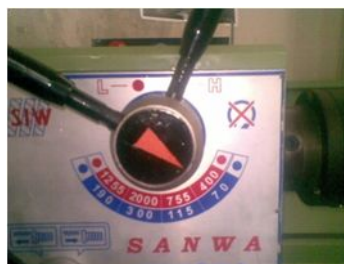
Gambar 4.41. Tuas dan tabel kecepatan mesin
