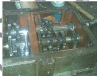
Gambar 4.49. Gearbox pengatur kecepatan otomatis
