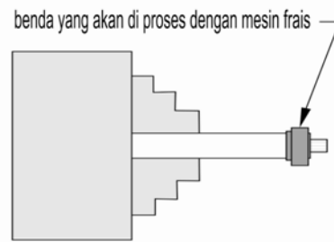
Gambar 4.21. Pemasangan benda pada poros bantu yang dicekam di mesin frais
