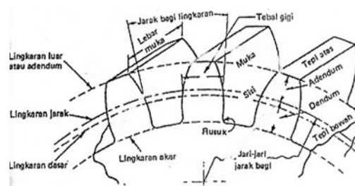
Gambar 3.9. Nama-nama bagian roda gigi lurus
