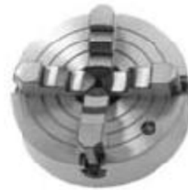
Pencekam dengan empat rahang (four jaw chuck)
