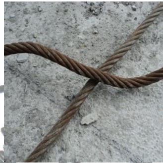
Gambar 12. Sling atau tali baja tower crane Sumber : PT. Tatamulia Nusantara Indah, 2011.
