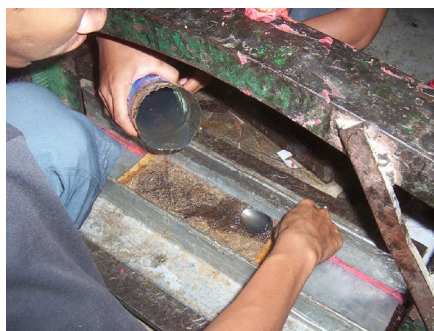
Gambar 3.6. Proses manufaktur komposit sandwich
