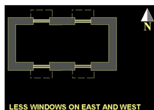
Gambar 2.5. Prinsip umum peletakan bukaan
