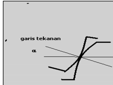
Gambar 2.8 Garis tekanan pada roda gigi.
