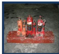
Gambar 3.2. Dongkrak hidrolik.
