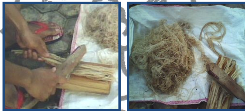
Gambar 3.11. Pelurusan serat rami
