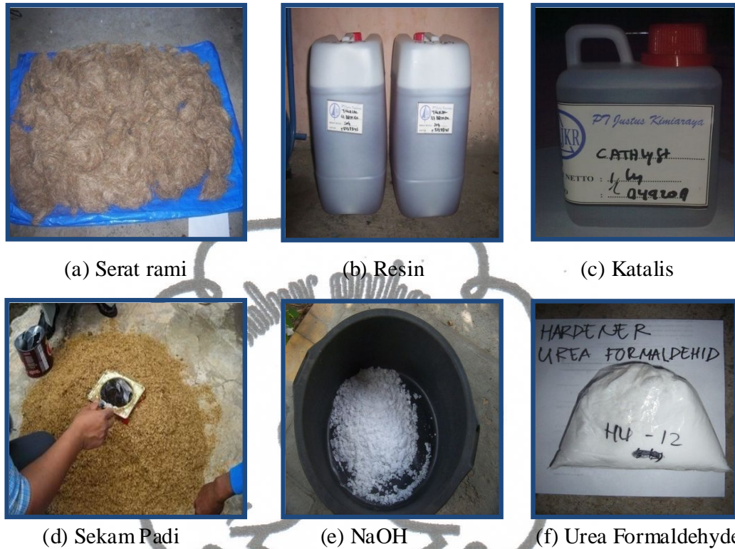
Gambar 3.1 Bahan penyusun komposit sandwich
