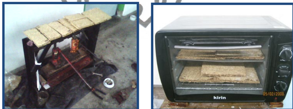
Gambar 3.13. Pencetakan core dan post cure core
