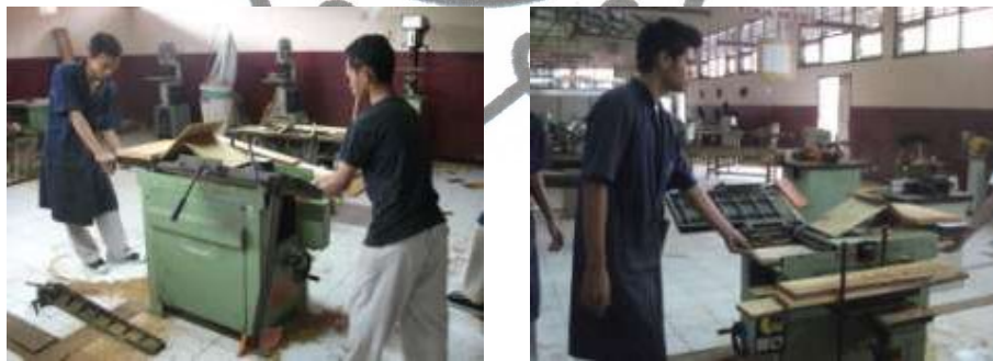
Gambar 23. Siswa Melakukan Pembahanan untuk Membuat Sambungan Kayu (Dokumentasi: Cahyanto, 2010)
