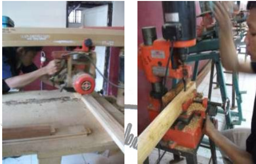
Gambar 15. Siswa Membuat Sambungan Kayu (Dokumentasi: Cahyanto, 2010)
