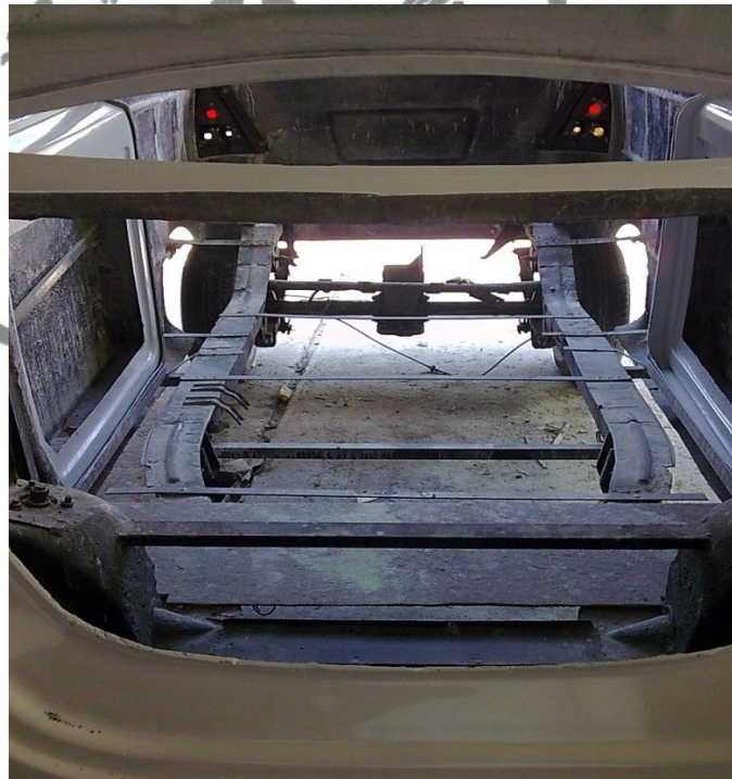
Gambar 4.1 Pembuatan rangka lantai mobil
