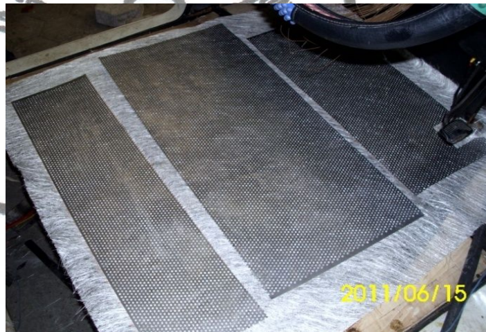
Gambar 4.7. Peletakan CSM, Woven roving dan Kawat penguat
