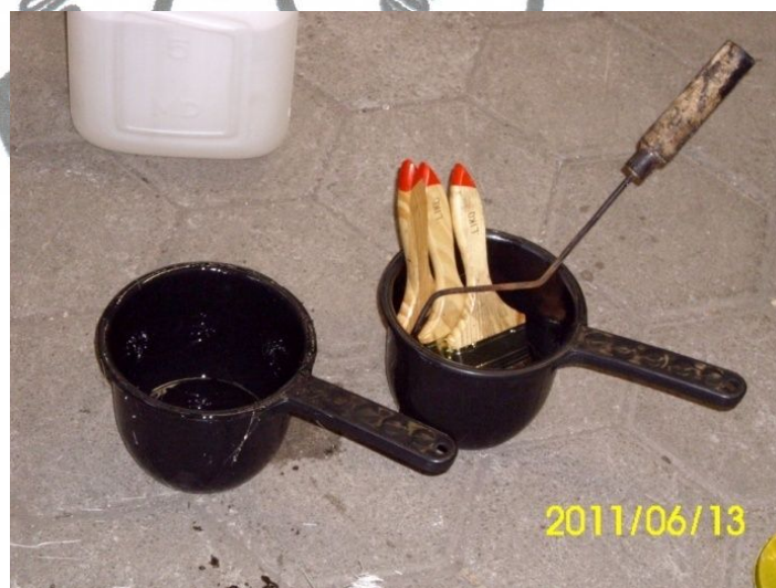
Gambar 4.6. Penyiapan Alat Peresinan
