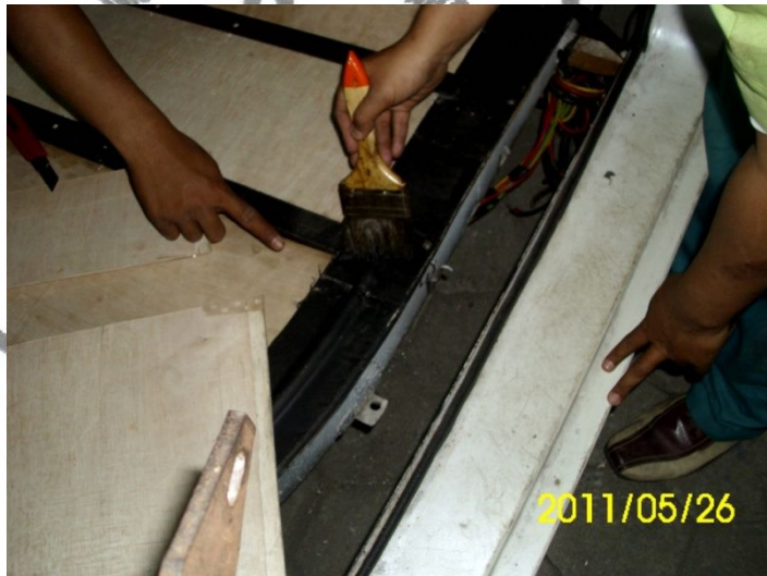
Gambar 4.2. Pengecatan anti karat rangka mobil
