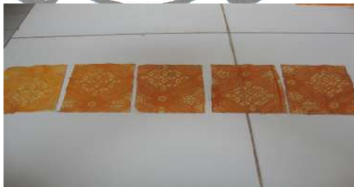
Gambar IV.3. Hasil Pencelupan dengan 1,2,3,4,5 gram Zat Warna dalam 100 mL Aquadest (Berurutan dari kiri ke kanan)
