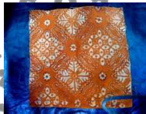
Gambar IV.15 Hasil Penghilangan Lilin pada Kain dengan Fixer Tawas
