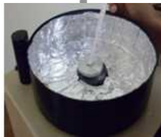
Gambar 3.10. Penetesan Larutan di atas Substrat
