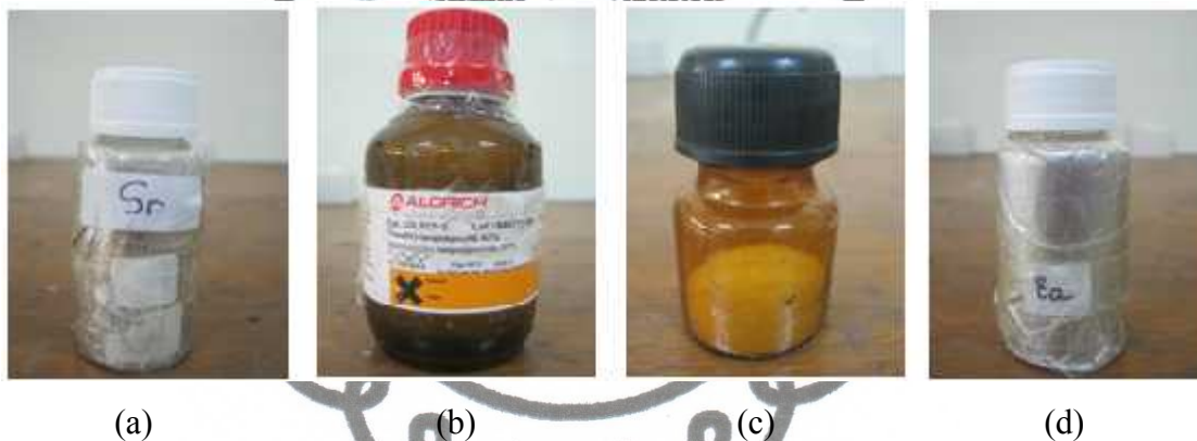
Gambar 3.5. Bahan Pelarut dan Bahan Terlarut (a) Strontium Asetat (b) Titanium Isopropopoksid (c) Lantanum Asetat (d) Barium Asetat
