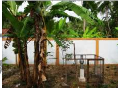
Gambar 2.2. Contoh Penempatan Alat Pencatat Hujan yang Salah
