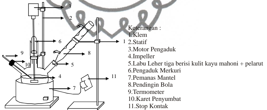
Gambar III.2. Rangkaian Alat Ekstraksi Batch
