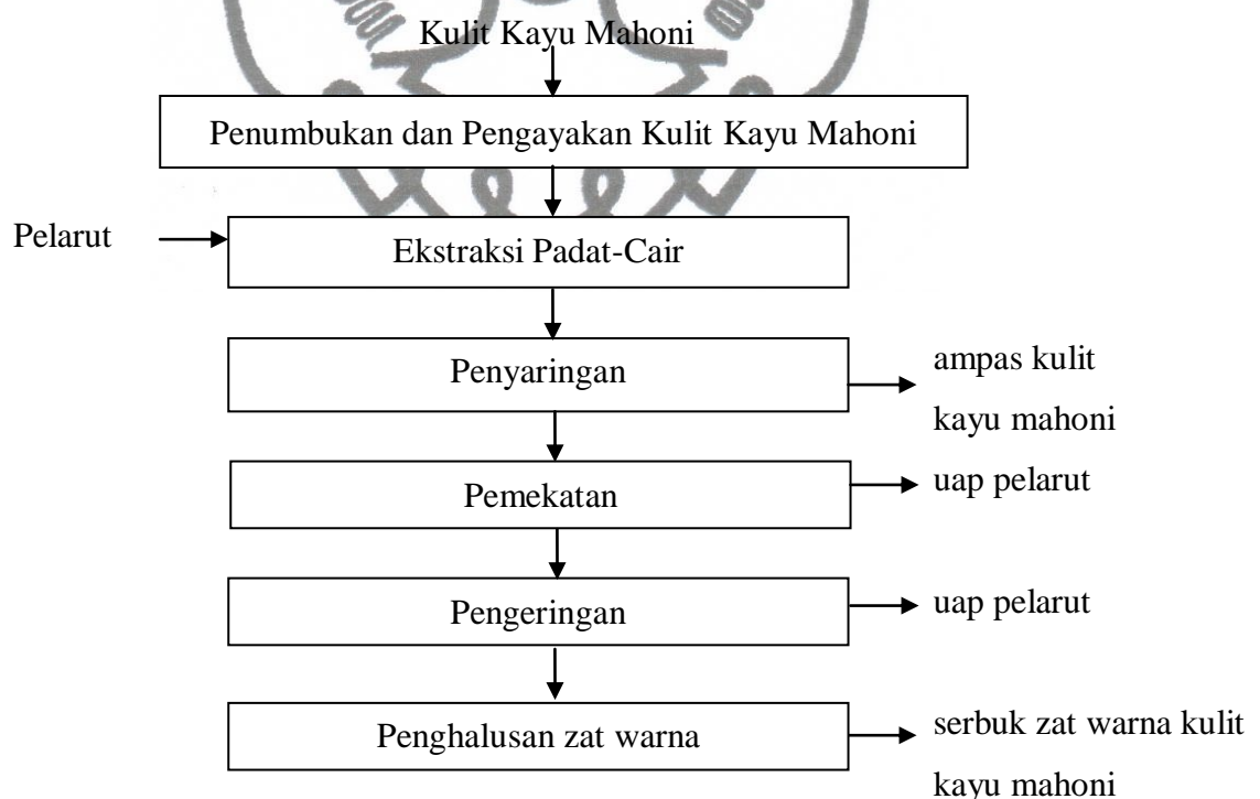
Gambar II.5 Diagram Alir Proses Pembuatan Zat Warna Alami dari Kulit Kayu Mahoni Menggunakan Ekstraksi Padat-Cair
