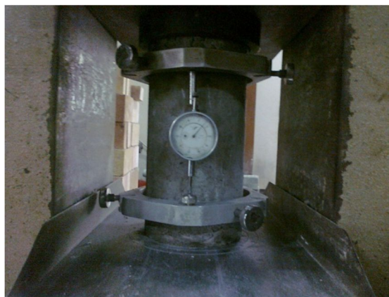
Gambar 3.5. Alat uji modulus elastisitas (CTM & extensometer )
