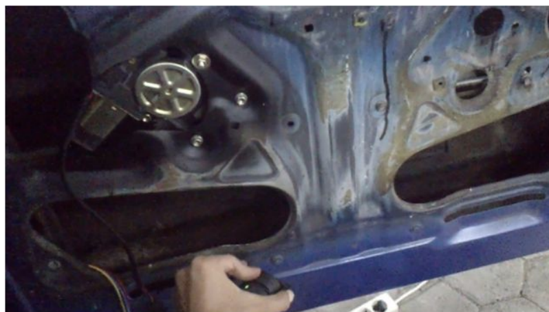
Gambar 4.41 Proses Uji coba Power windows dengan saklar
