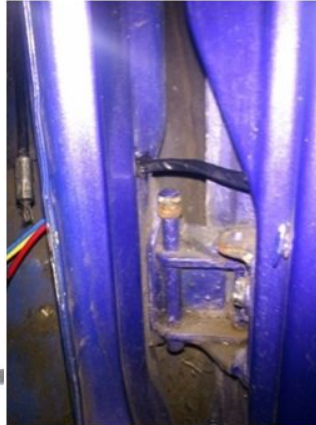
Gambar 4.23 Jalur Kabel utama power windows pintu kanan
