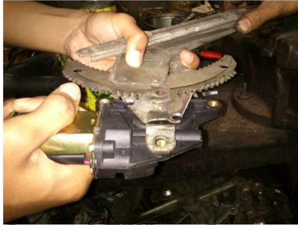
Gambar 4.10 Proses pemosisian plat dudukan
