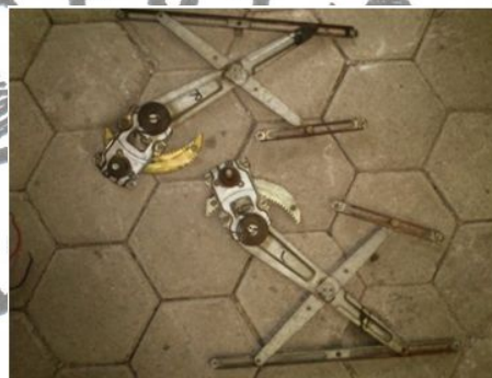
Gambar 4.3 Regulator asli kedua pintu
