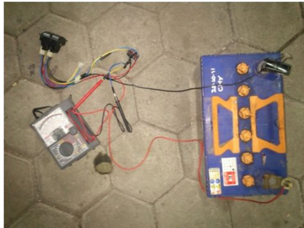
Gambar 4.25 Uji Coba saklar Power windows (kanan)
