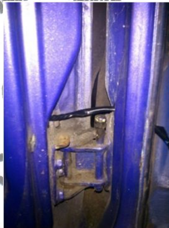
Gambar 4.24 Jalur Kabel utama power windows pintu kiri
