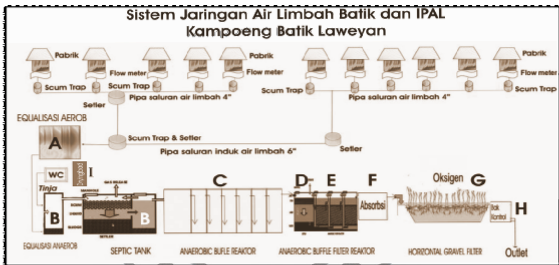
Gambar IV.I Proses Sistem Jaringan Air Limbah Batik dan IPAL Kampung Batik Laweyan
