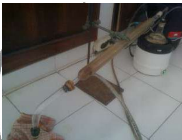
Gambar II. 3 Rangkaian Alat Destilasi
