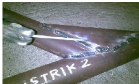
Gambar 4.7. sambungan rangka
