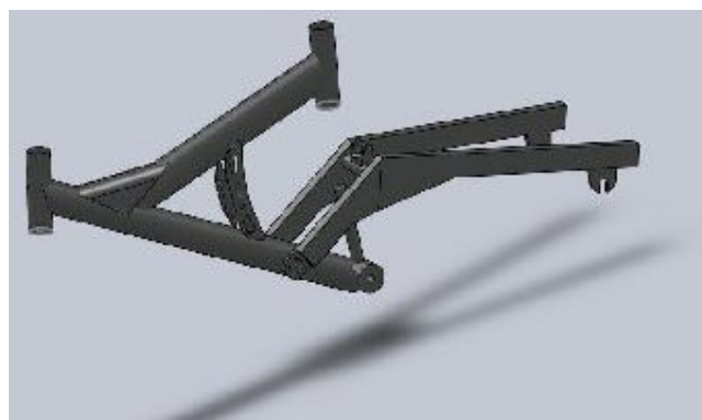
Gambar 3.5. Rangka Sepeda Listrik
