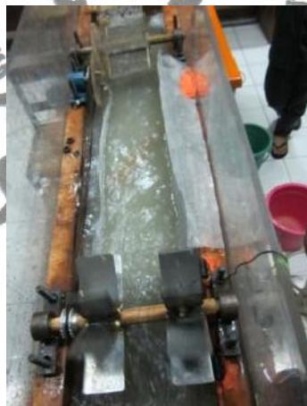
Gambar 3-7. Prototipe Kincir Air Pengangkat Sampah Dengan Dua Kincir Penggerak.
