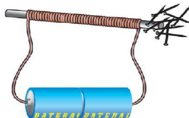
Gambar 2.5 Pembuatan Magnet dengan Mengalirkan Arus Listrik
