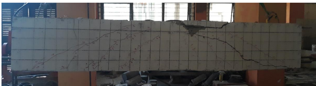
Gambar 4.18 Foto Retakan Balok BS-300A.
