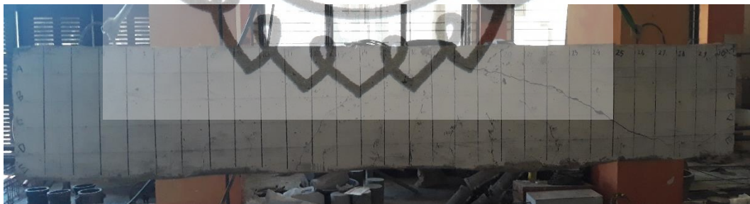
Gambar 4.12 Foto Retakan Balok B-0.
