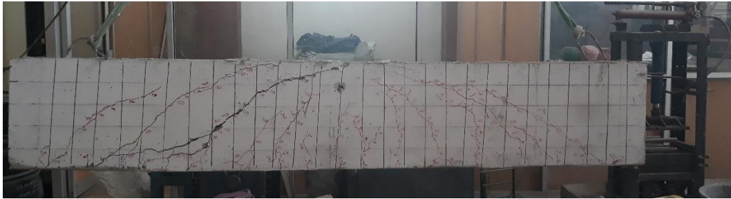
Gambar 4.14 Foto Retakan Balok BS-250A.
