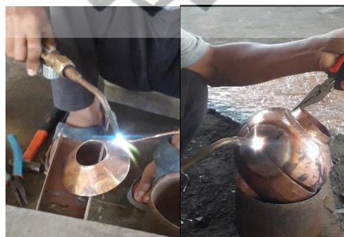
Gambar 4. 16. Proses pengelasan pada bidang datar dan bidang lengkung. (Dokumentasi: Niko, 2020)
