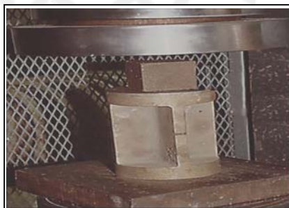
Gambar 2.6 Penampang alat uji kuat desak
