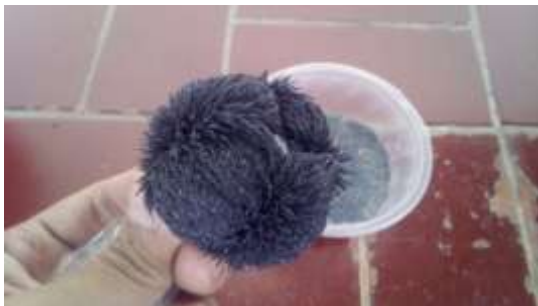
Gambar 1. Pasir besi menempel pada magnet permanen
