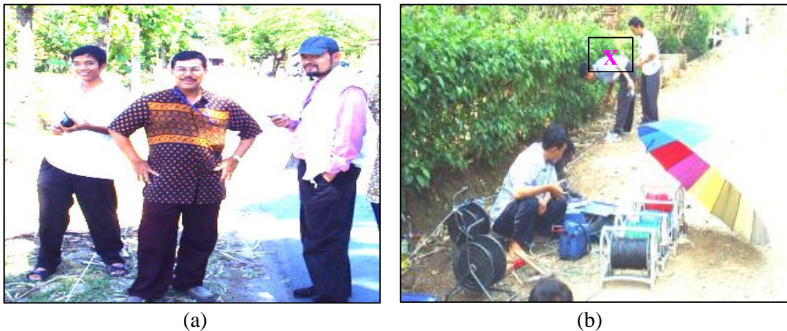
Gambar III.1 (a) Pengambilan data bersama Tim Satu di Kec.Plupuh 1 . Gambar III.1 (b). Pengambilan data geolistrik bersama Tim Dua di Kec. Plupuh 2. Tanda silang X adalah peneliti sedang melakukan penancapan elektroda.
