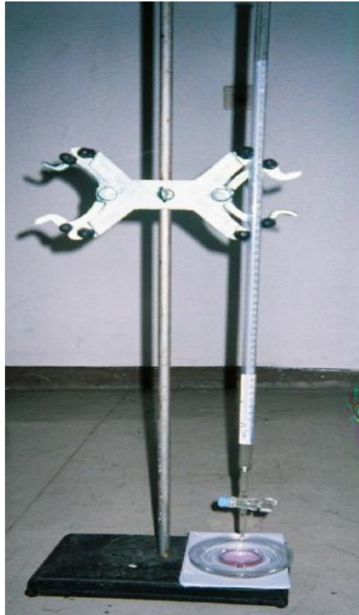
Gambar 6. Pengukuran kadar TVB dengan metode titrasi.
