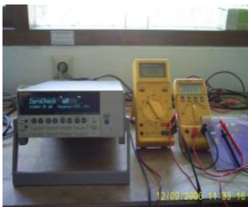
Rangkaian two point probe dengan Keithley
