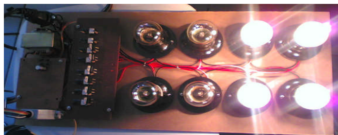
Gambar 4.11 Pengujian Rangkaian Port Paralel
