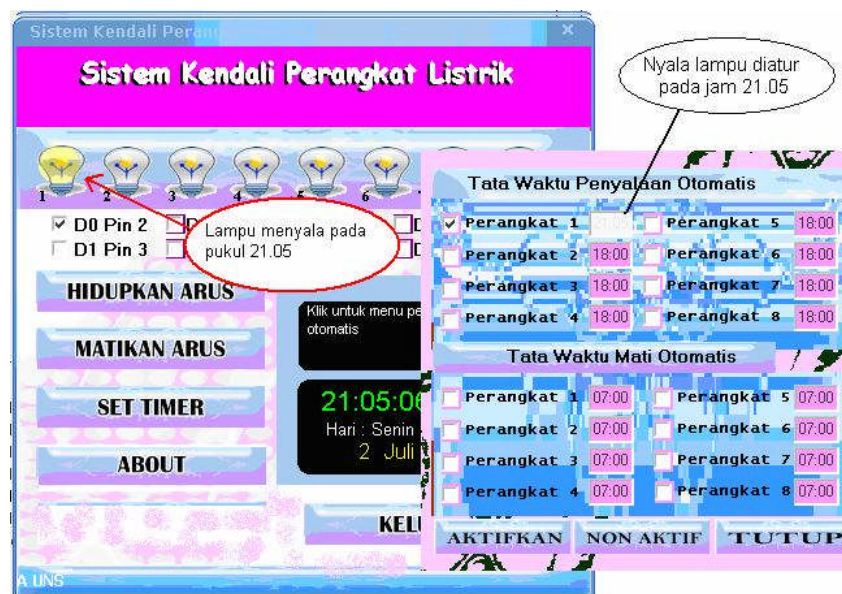
Gambar 4.4 Hasil pengujian sistem timer waktu (Lampu Menyala)
