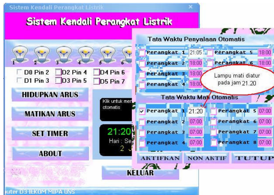
Gambar 4.5 Hasil pengujian sistem timer waktu (Lampu Mati)
