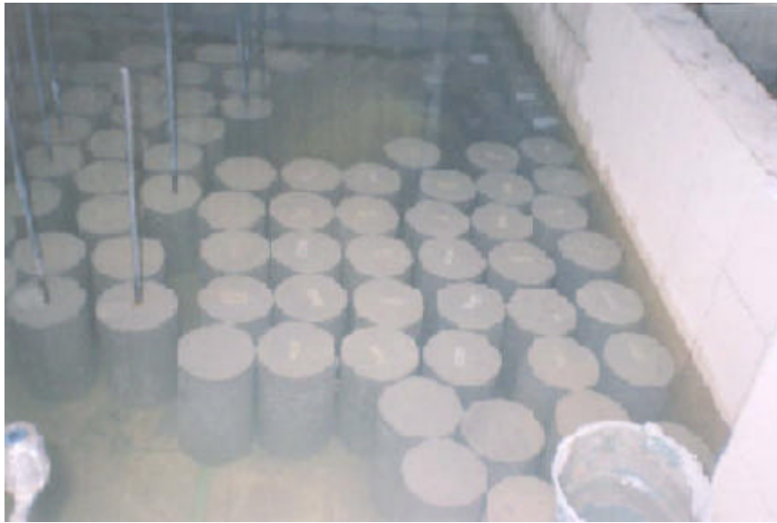
Gambar E.11 Perendaman Benda Uji
