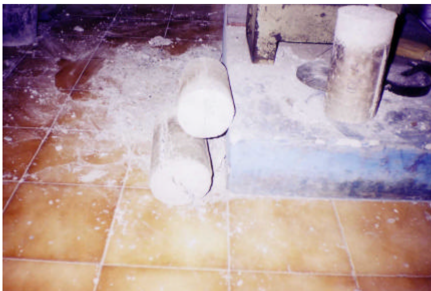
Gambar E.14 Benda Uji Setelah Diuji Kuat Tarik Belah dengan Compression Testing Machine
