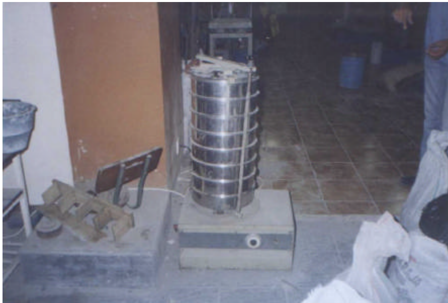
Gambar E.2 Ayakan Baja Merek Controls Italy , Untuk Uji Gradasi Agregat
