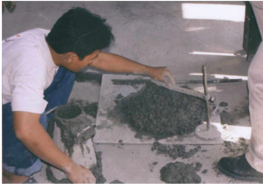
Gambar E.7 Pengujian Nilai Slump
