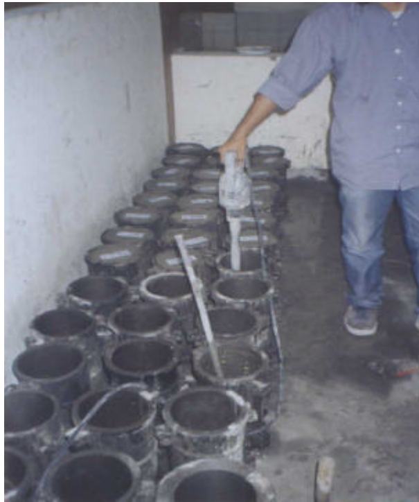
Gambar E.9 Pemadatan dengan Menggunakan Vibrator
