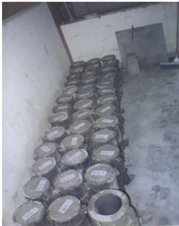
Gambar E.10 Benda Uji Silinder
