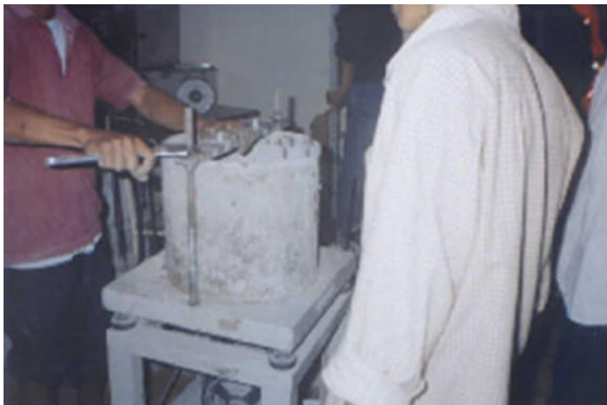
Gambar E.8 Pengujian Nilai YB-Time diatas Meja Getar
