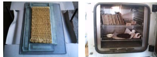
Gambar 7. (a) proses pembuatan komposit face (b) proses post cure
