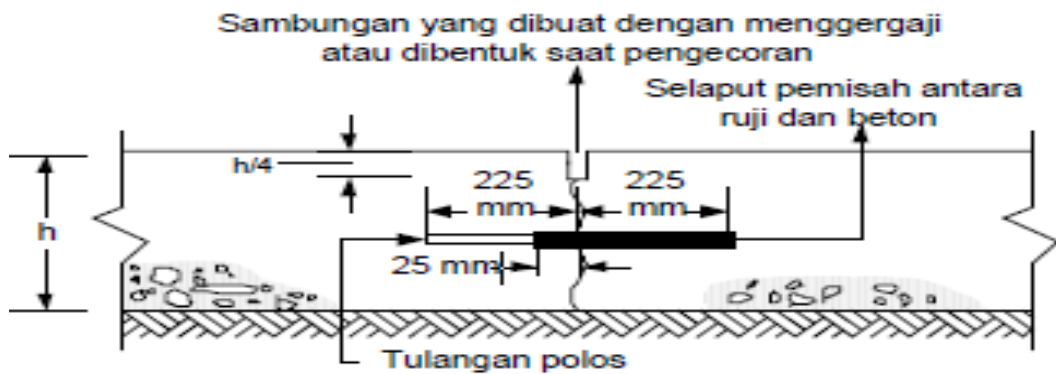
Gambar 2.13 Sambungan Susut Melintang dengan Ruji
