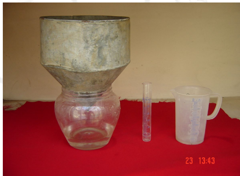
Lampiran 19. Gambar alat pengukuran kapasitas lapang (metode gravimetri)
