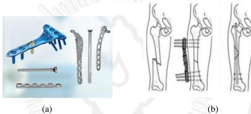
Gambar 2.1 (a) Pelat dan sekrup tulang; (b) Pemasangan DCP internal dan eksternal
