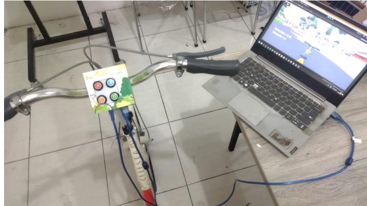
Gambar 4.23 Pengujian hardware melakukan koneksi hardware dan software, kalibrasi, dan pengontrolan game.
